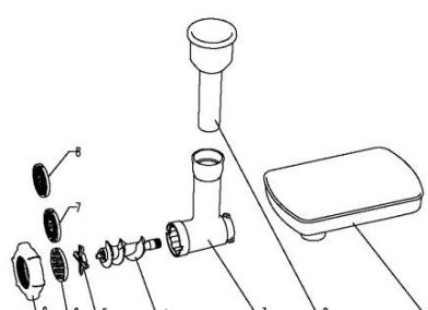
Assemblage de l'unité: mettre la spirale (4) à l'intérieur du hachoir (3), la lame (5) sur la spirale et l'un des disques (6, 7 ou 8) sur la lame. Choisissez le disque en fonction du type de hachage que vous souhaitez obtenir. Bloquer les éléments en vissant l'anneau (9).
